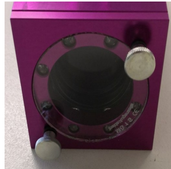
Rändelschrauben zur Sicherung des Schutzglases
