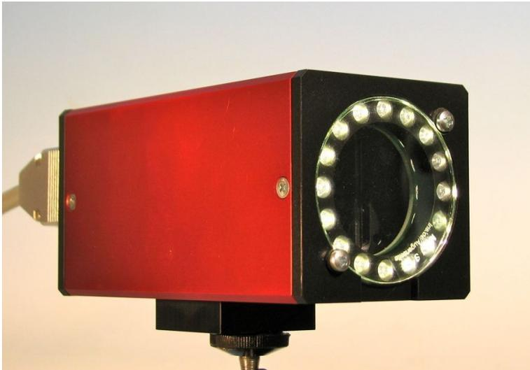
An der Vorderseite der Kamera ist ein Schutzglas eingelegt, das sich nach lösen der beiden Rändelschrauben leicht wechseln lässt.
